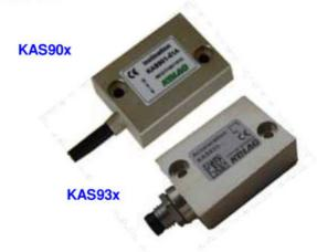
Die Sensoren beruhen auf einer weiterentwickelten "bulk micromachined"-Technologie. Die dreidimensionale Struktur der Sensorelemente beinhaltet ein Pendel aus einkristallinem Silizium. Dieses ist hermetisch zwischen zwei Siliziumplatten eingeschlossen. Daraus resultiert ein langzeitstabiler, hochauflösender und schockfester Sensor. Eine Gasdämpfung im Messelement verhindert ein Überschwingen und störende Resonanzschwingungen.
